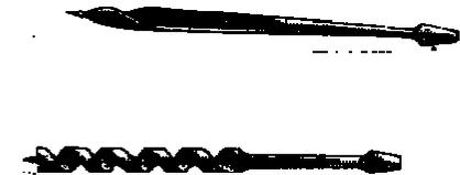
Tutte le trivelle, sia che si usino a mano che con il girabacchino devono essere fatte ruotare molto lentamente perché altrimenti si rischia di sfilare il legno e la vite di trascinamento perderebbe la sua funzione compromettendo la riuscita del foro.
